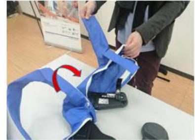
Step 15 – A) tournez le boîtier du générateur de puissance vers le haut comme indiqué dans la flèche de la figure B) Reprenez la housse et commencez à l'insérer depuis le boîtier du générateur de puissance
