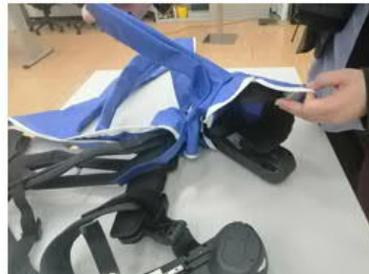
Step 17 – Commencez à insérer le boîtier du générateur de puissance dans la housse
