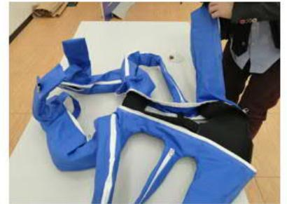
Step 30 – Insérez la ceinture de l'exosquelette dans la housse
