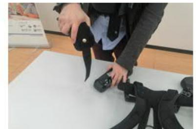
Step 12 – Prenez l'exosquelette et retirez la partie textile du brassard de l'exosquelette en ouvrant le bouton de pression
